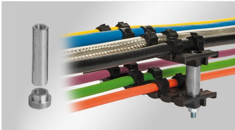
La pose multi couche permet de monter les supports de câbles sur plusieurs niveaux pour obtenir une densité plus importante. Pour cela, on utilise des douilles d'écartement du type DH.
