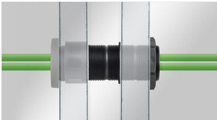
Los [prensaestopas](#) y [pasacables](#) de icotek con roscas de paso 1.5mm se sujetan mediante una contratuerca. En ciertos casos la longitud de la rosca no es suficiente para atravesar la pared, por ejemplo en paneles sandwich o muros de hormigón. Para ello icotek ofrece una práctica solución: ¡El prolongador de rosca de icotek!
